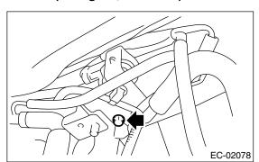
Pressure Control Solenoid Valve EMISSION CONTROL (AUX. EMISSION CONTROL DEVICES)
