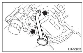
17) Remove the baffle plate.
