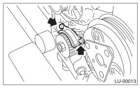
12) Remove the crank sprocket.
