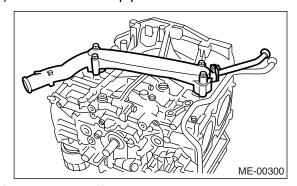
21) Install the baffle plate.
