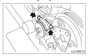
13) Remove the crank sprocket.
