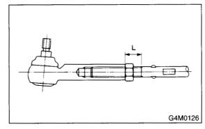
29) Install the tie-rod end plate.
